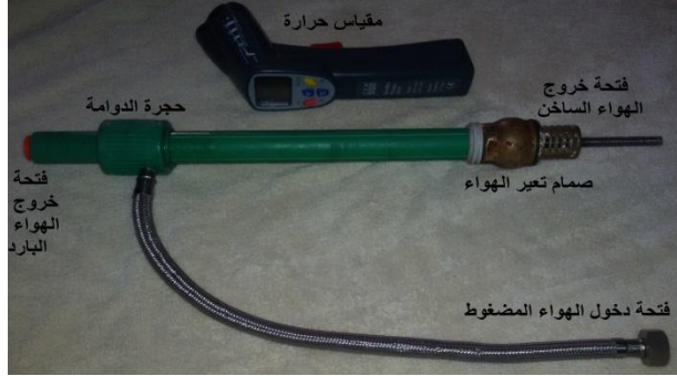
الشكل (6) يوضح النموذج التجريبي لأنبوبة إعصارية (PVC)
