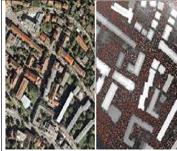
الشكل (9) منطقة الدراسة للمثال الرابع نقاط الغمامة المتبقية بعد الفلترة باللون الأحمر (Sample12)
