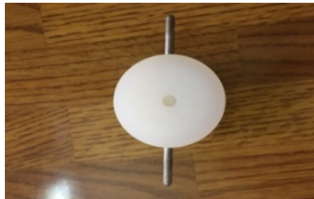
الشكل (1) القالب التيفلوني المستخدم لتحضير أقراص الكمبيوتر.
