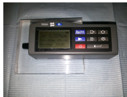
الشكل (2) جهاز قياس خشونة السطح TR200
