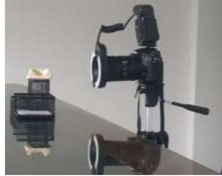
الشكل (2): وضعية وضعية الكاميرا المستخدمة لتصوير العينات
