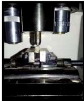
الشكل (12): تطبيق حمولة 200 غ بزمن تحميل 15 ثانية بواسطة رأس ماسي.
