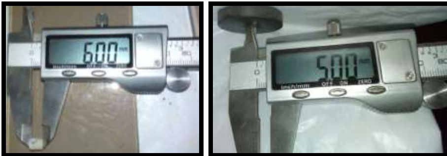
الشكل (5): مقياس ثخانة الكتروني (بياكوليس) Digital Clipper للتأكد من أبعاد العينات.
