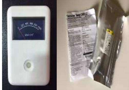
الشكل (1): مادة الأكريل المؤقت المستخدمة في الدراسة وجهاز قياس شدة ضوء جهاز التصليب.
