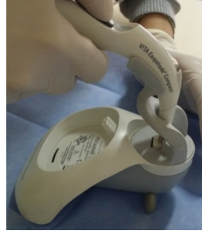
الشكل (3) جهاز VITA Easy Shade Compact في أثناء المعايرة
